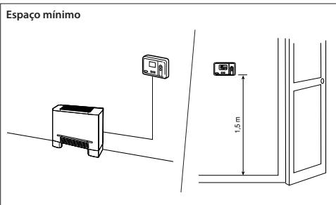
Em caso de aplicação na parede, o Room Controller 2 deve ser montado:
