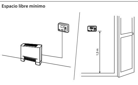
En caso de aplicación en la pared, el Room Controller 2 debe estar montado:
