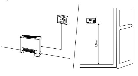
En cas d'application au mur, le Room Controller 2 doit être monté :
