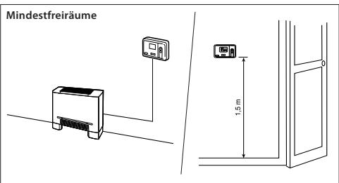
Bei Befestigung an der Wand muß der Room Controller 2 wie folgt montiert werden:
