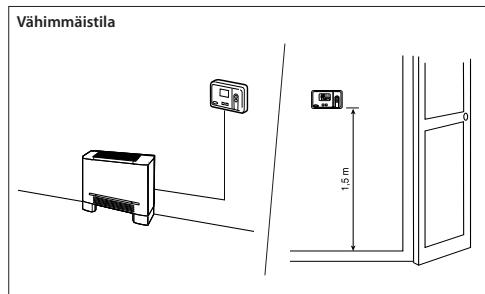
Jos Room Controller 2 kiinnitetään seinään, se on asennettava:
